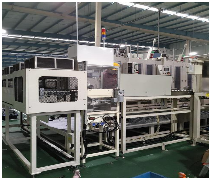
某日资企业 称重输送机，检测精度0.2%
